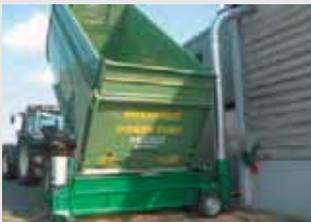
Hackschnitzeltroggebläse - Antrieb: E-Motor bzw. Traktor
