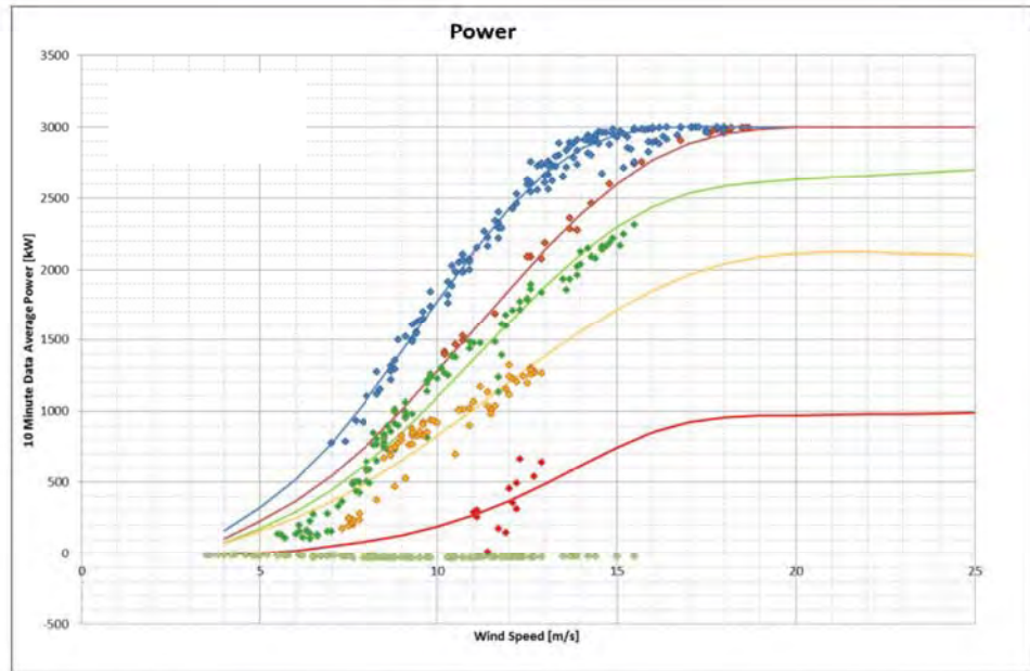
Abbildung 3. Diagramm, das eine Standardleistungskurve (blau) im Vergleich zu durch Eis beeinflussten Leistungskurven während einer Vereisung zeigt. Basierend auf einer V90 3MW-Anlage an einem Standort mit starkem Eisverlust in Schweden.
