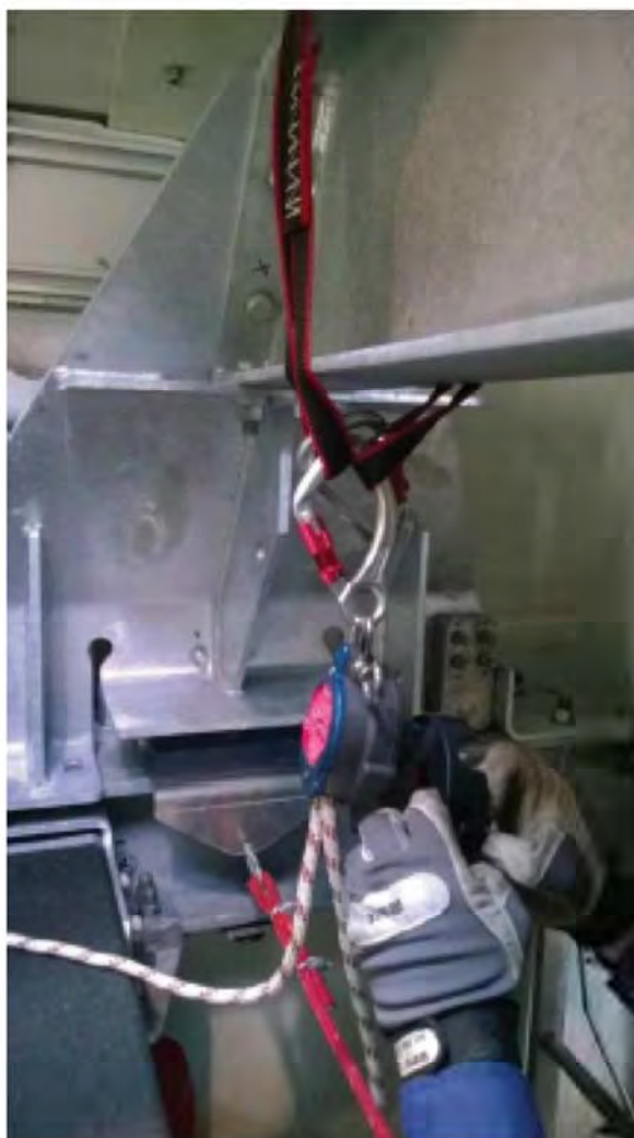
Abbildung 7.20: Die Abstiegsvorrichtung am beweglichen Ausleger befestigen
