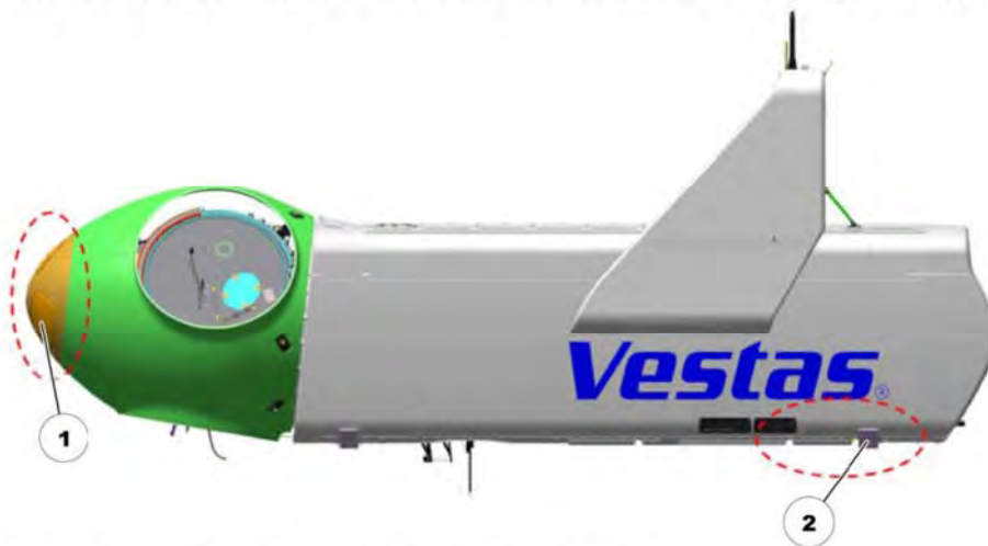
Abbildung 48: Fluchtpunkt in Nabe und Maschinenhaus
