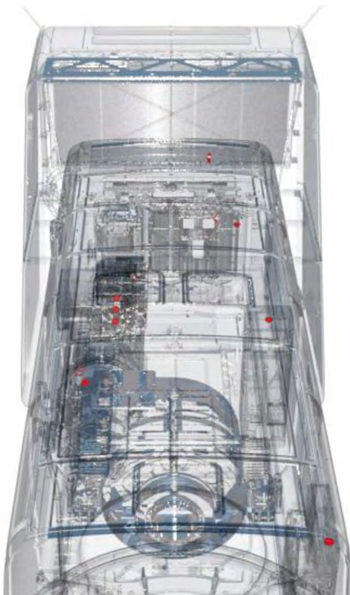
Abbildung 73: Rauchmeldeanlage (rot) im Maschinenhaus
