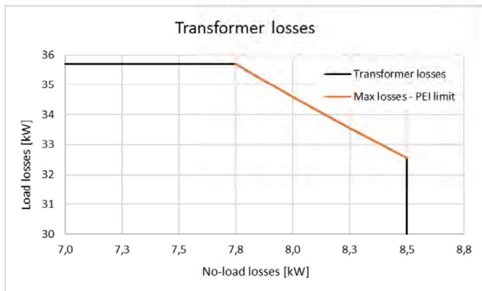
Abbildung 4-1 Transformatorverluste – zulässiger Bereich
