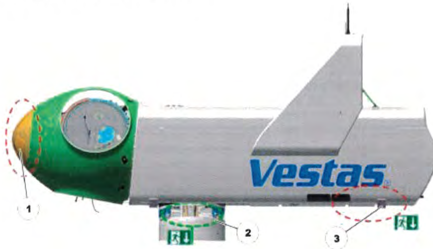
Abbildung 11: Fluchtwege aus dem Maschinenhaus der 3/4MW bzw. EnVentus Plattform (Darstellung ¾ MW Plattform)
