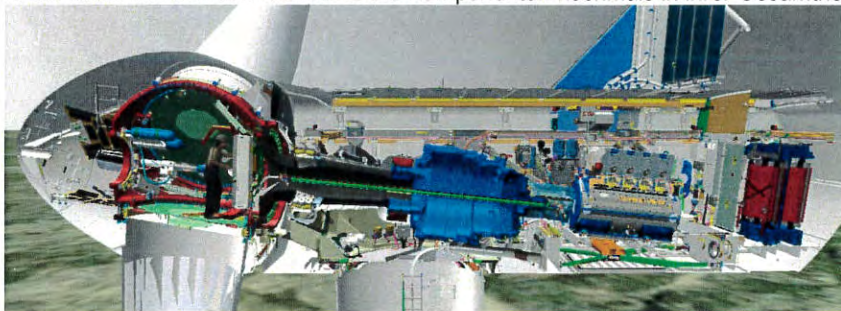
Abbildung 52: Seitenansicht, Schnittdarstellung Maschinenhaus
