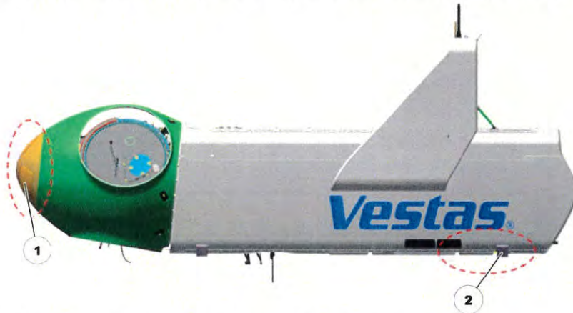
Abbildung 48: Fluchtpunkt in Nabe und Maschinenhaus
