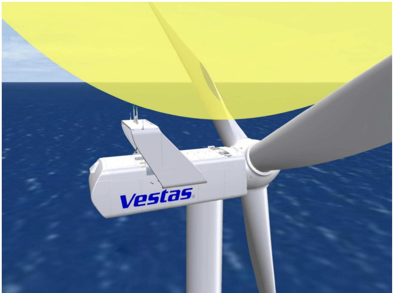
Abbildung 6.2: Blitzkugelberechnung für CoolerTop® (Version Mk 1)
