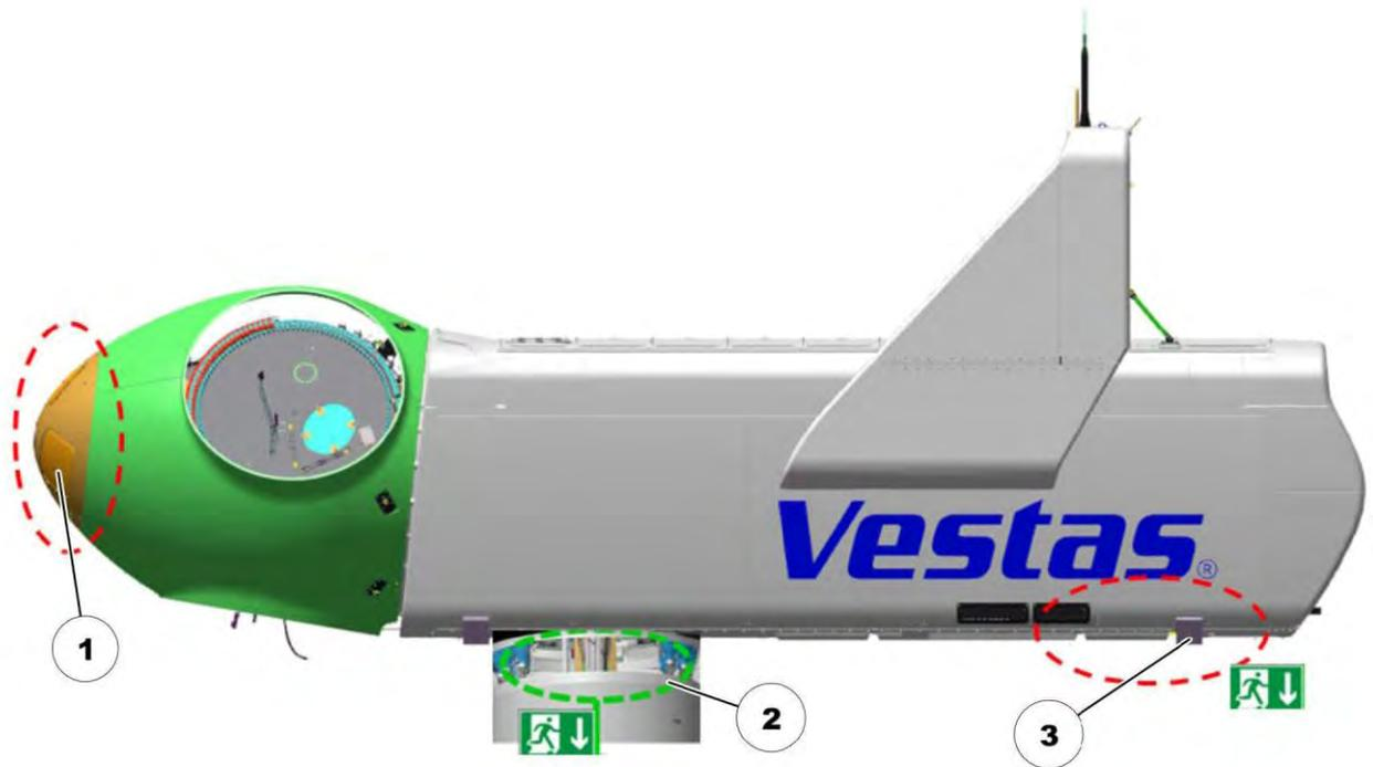
**Abbildung 7.1: Evakuierungsrouten (ER), Fluchtpunkte (EP) und Rettungspunkte (RP) in Maschinenhaus und Nabe**
