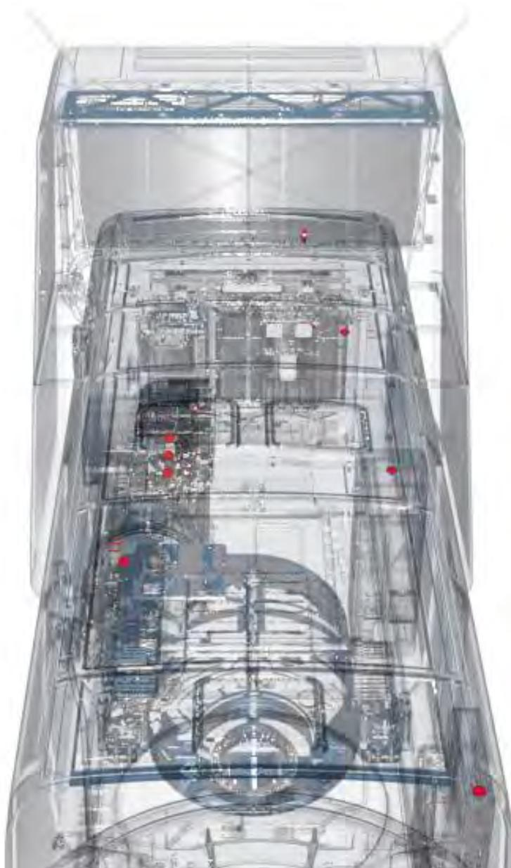
Abbildung 73: Rauchmeldeanlage (rot) im Maschinenhaus
