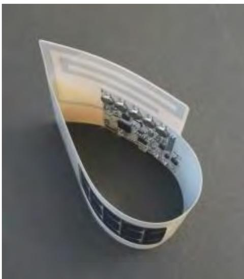
Bild 3 Darstellung der mechanischen Flexibilität des Sensors
