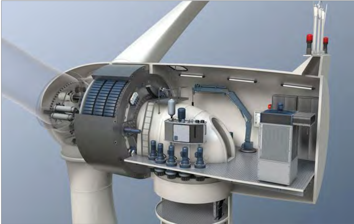
Abbildung 9: Maschinenhaus mit Triebstrang und elektrischen Komponenten der Baureihe SIEMENS 3.0 MW
