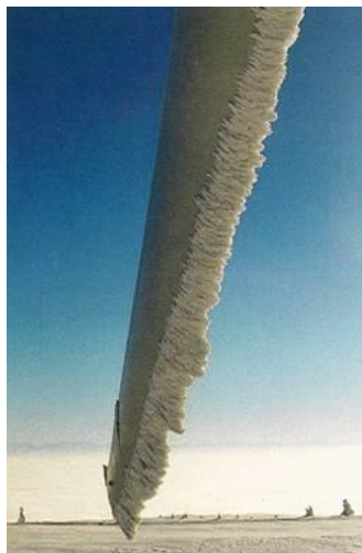
Abbildung 7-2: Ansammlung von Eis auf dem Rotorblatt und Cooler Top®
