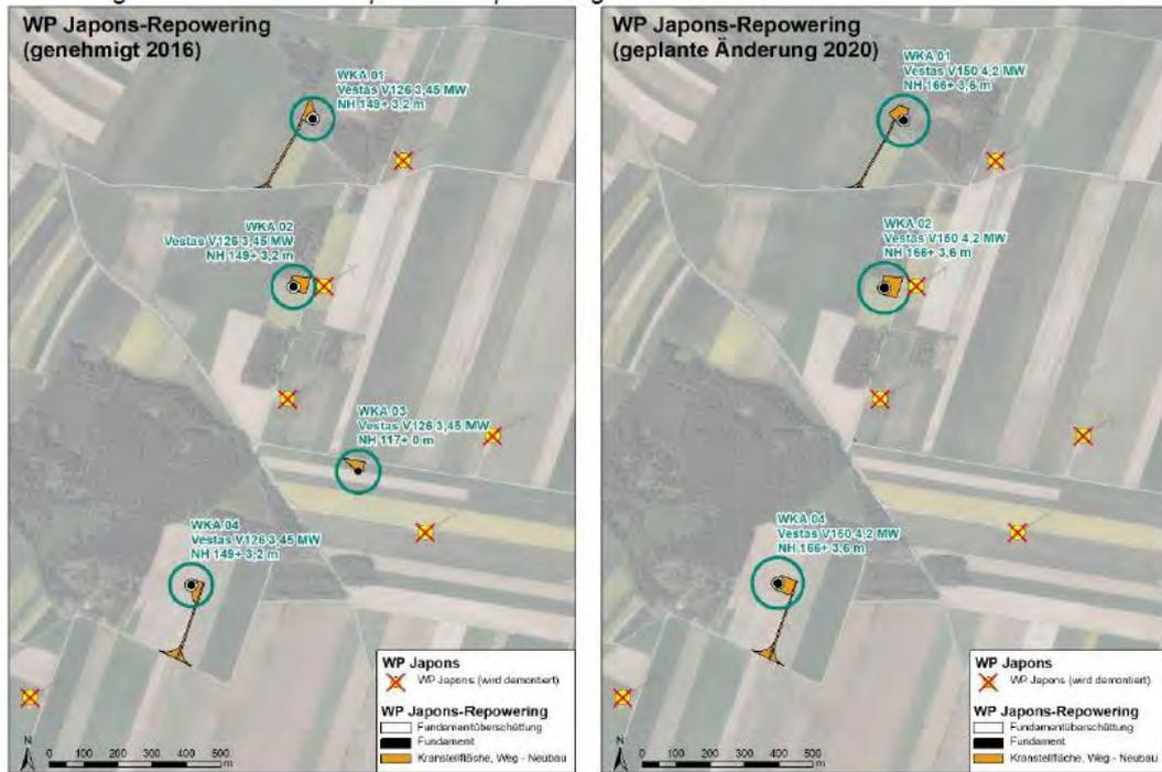
Abbildung 1: Überblicksdarstellung der aktuellen Planung mit Vestas V150 Anlagen und dem 2016 genehmigten Projekt (Quelle: Einreichunterlagen 2020)
